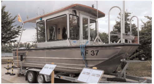
Das ADCP-Messboot 2015 gebaut, 6m lang und 2,20 breit und nur 0,25m Tiefgang. Mit 60 PS hat es sein Einsatzgebiet von der Schweizer Landesgrenze(Basel) bis Mainz. Es erfasst die Abflusswerte in m³/sec, sowie die Vertiefung der Fließgeschwindigkeiten über die Breite und Tiefe. Es ist mit 1 Bootsführer und 1 Messleiter besetzt.
